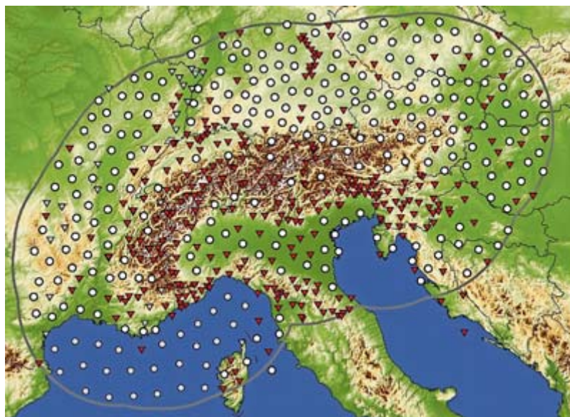
Das Alp-Array-Projekt überzieht die Alpen mit einem dichten Netz von seismischen Messstationen: Die roten Dreiecke sind ständig installierte Geräte, die Punkte stehen für zusätzliche Seismometer im Rahmen des Projekts – unten links die Messpunkte im Ligurischen Meer. Grafik Alp Array
